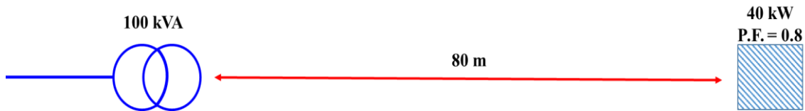
شکل (۳ - ۱۳) موقعیت مشترک و شبکه برای مثال برقرسانی به یک کارگاه در انتهای بن‌بست
