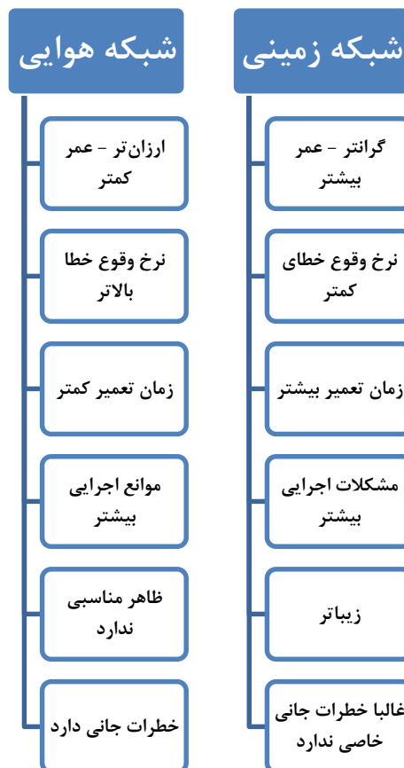
شکل (۱-۱۲) مقایسه کلی بین شبکه هوایی و زمینی توزیع برق
