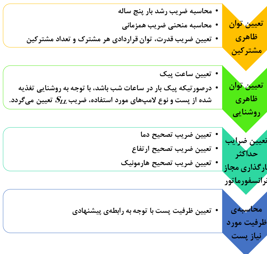
شکل (۳-۴) فلوچارت کلی تعیین ظرفیت پست توزیع
