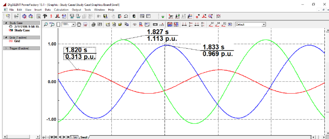
شکل (۳-۱۰) تغییرات ولتاژ سه‌فاز در شرایط رخداد خطای تکفاز به زمین در یک شبکه‌ی زمین شده با امپدانس
